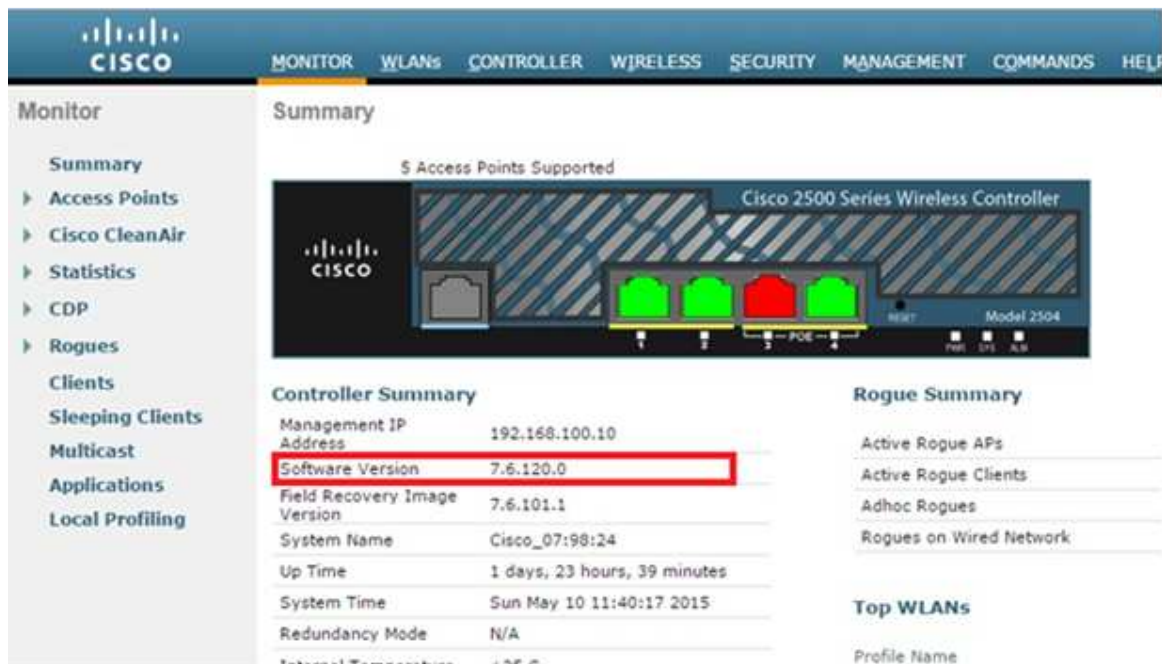
Figura 5.3.2 Menú principal de la controladora
