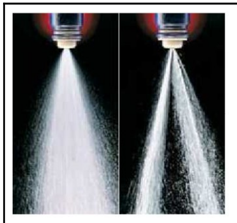
Figura 13. Atomización correcta e incorrecta de combustible
