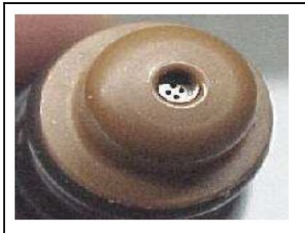
Figura 5 Inyector con válvula de disco
