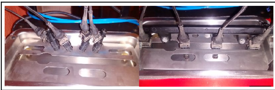
Figura 15 Limpieza ultrasonica de inyectores
