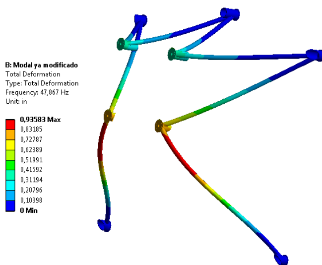
Figura 9.2: Modo de oscilación natural #1 para la nueva configuración
