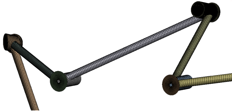
Figura 8.2: Geometría mallada de la bancada motor
