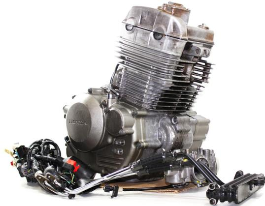
Figura 19: Motor Honda 250 CC de la motocicleta Twister
