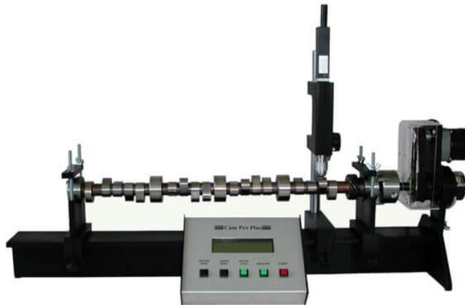
Figura 25: Dispositivo para relevamiento de levas *Cam-Pro-Plus*
