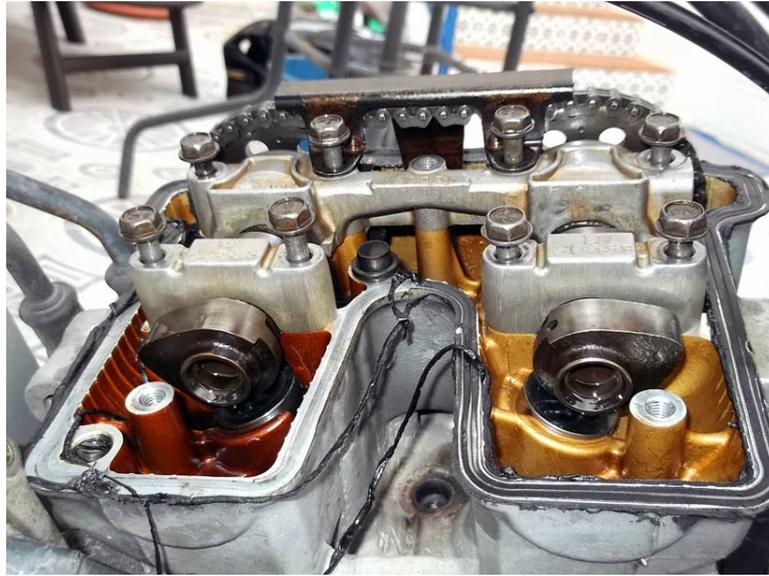
Figura 24: Arboles de levas del motor original Honda 250 CC
