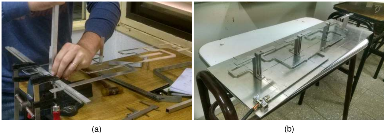
Figura 5.3: (a) Proceso de armado de una columna (b) Columna terminada
