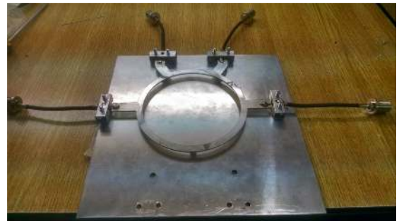
Fig. 9: Acoplador Híbrido de 180^\circ
