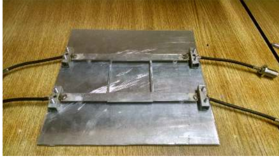
Fig. 10: Acoplador Híbrido de 90°
