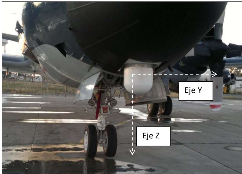
Ilustración 2-15 Dirección de los ejes de lectura de los acelerómetros “Y”, “Z”
