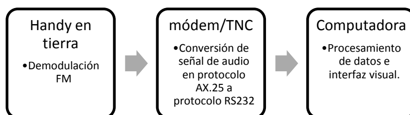
Figura 9 Esquema de sistema de recepción de tramas en tierra
