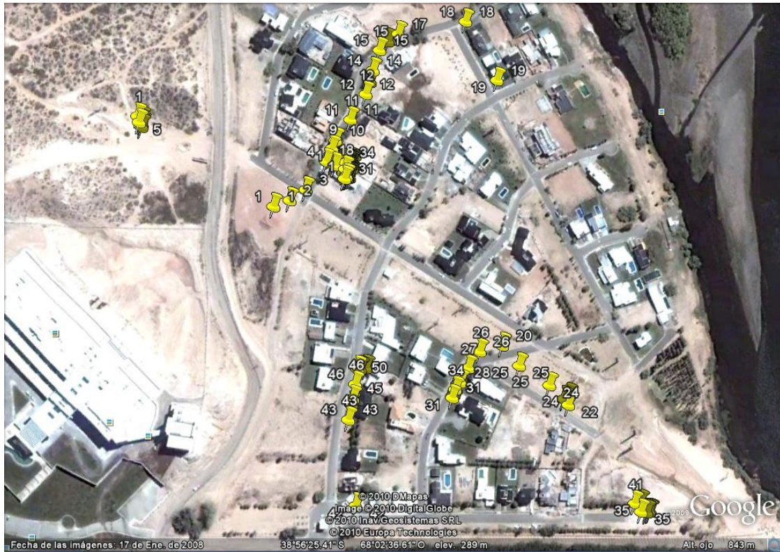
Figura 11 Captura de pantalla de Google Earth con los puntos marcados por el programa en la PC representado los puntos recibidos por la trama GPGGA obtenidos en un ensayo de campo
