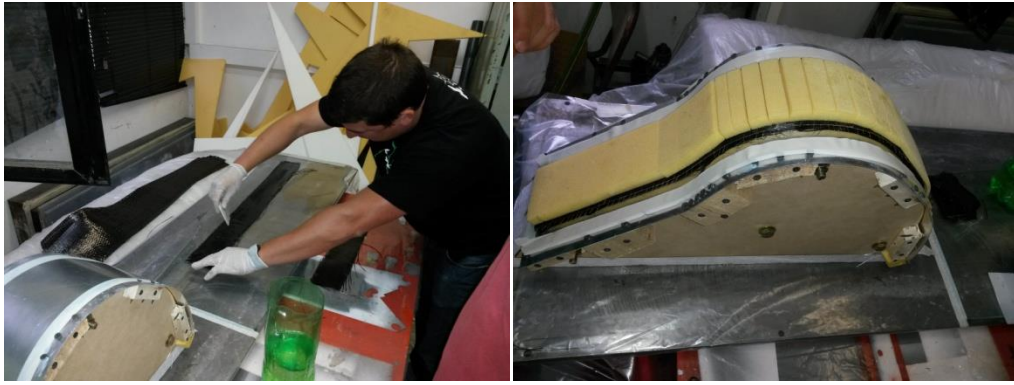
Figura 8 Impregnado y laminación sobre el molde
