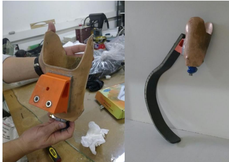
Figura 18 Pegado del anclaje y conjunto terminado
