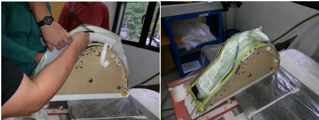
Figura 9 Colocación del “bleeder”, bolsa de vacío y conformado.
