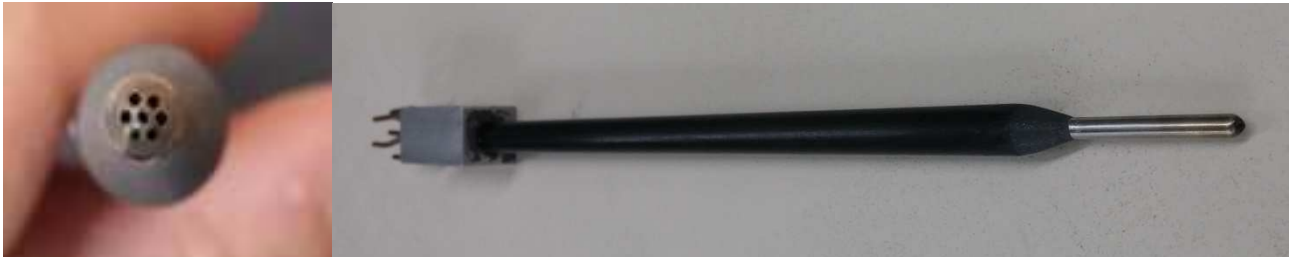
Figura 24: vista de la cabeza de la sonda de 7 agujeros (izquierda) y vista general (derecha)
