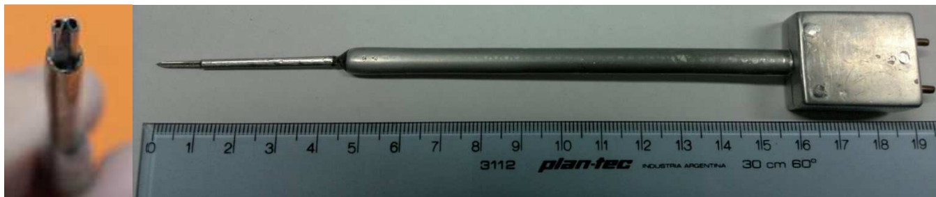
Figura 21: vista lateral de la sonda de 2 agujeros
