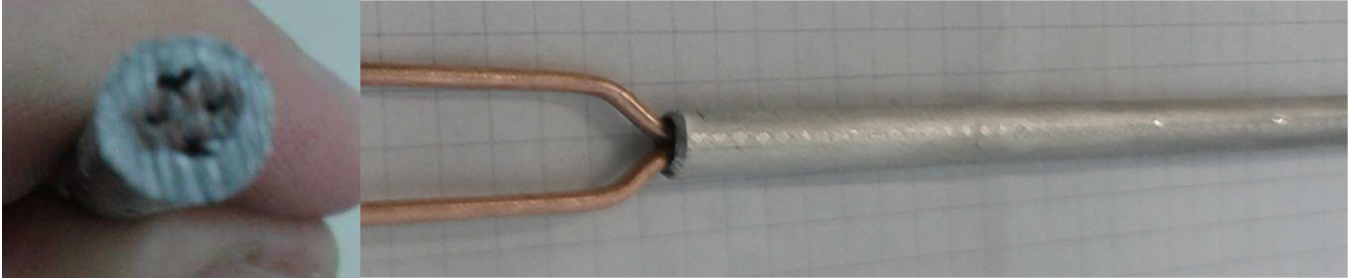
Figura 18: tubos de cobre y funda principal
