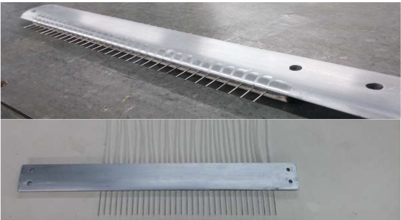
Figura 9: Rakes de presión total (arriba) y estática (abajo)
