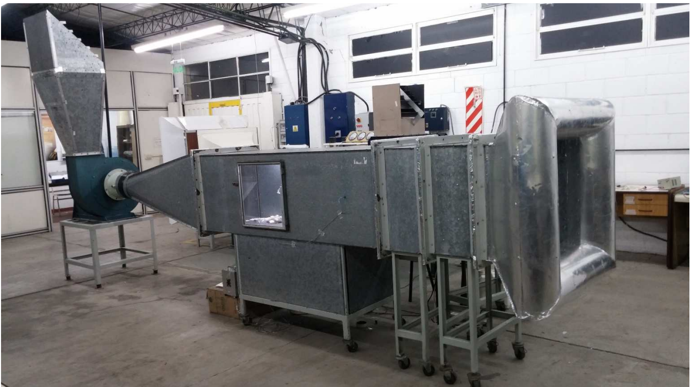
Figura 8: Vista general del túnel de viento
