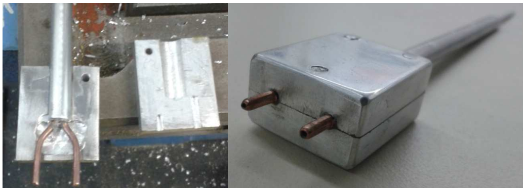
Figura 20: vista de detalle del soporte de la sonda
