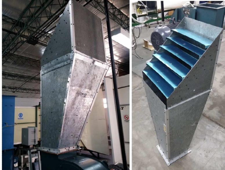
Figura 7: Difusor montado en túnel (izquierda) y detalle del deflector de flujo (derecha).
