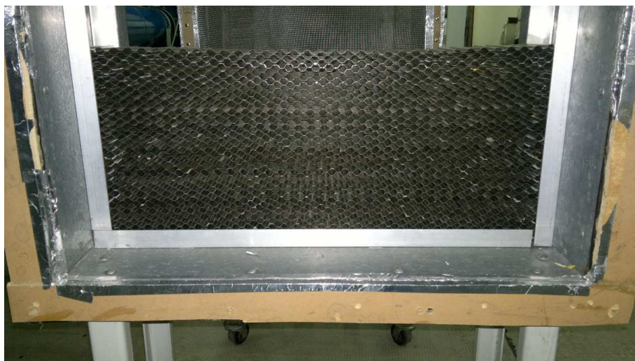
Figura 5: montaje (en curso) del honeycomb en panel desmontable
