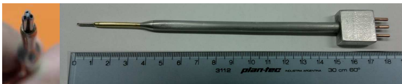
Figura 22: vista de la cabeza de la sonda de 3 agujeros (izquierda) y vista general (derecha)
