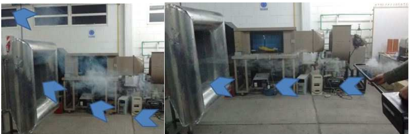
Figura 11: sin difusor ni cascada de alabes (izquierda) – con difusor y cascada de alabes (derecha).
