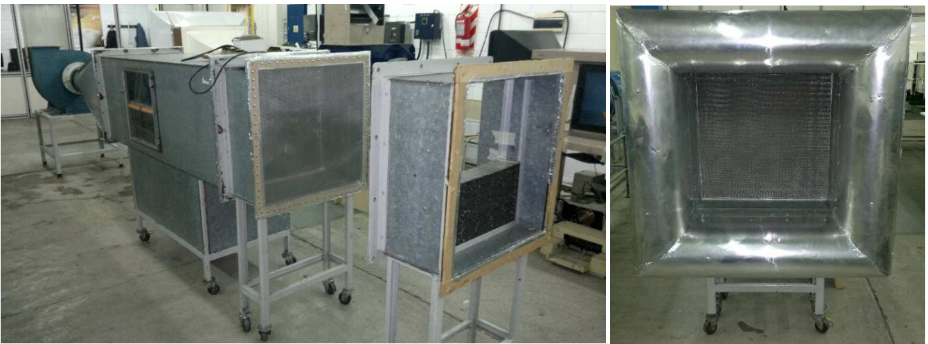
Figura 6: Detalle armado de una de las mallas finas (izquierda) y malla gruesa montada (derecha).
