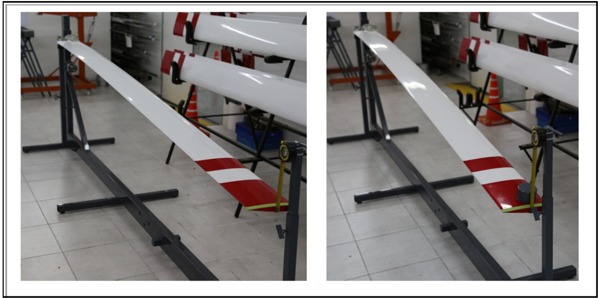
Figura 8: Pala de Cicaré 7 – Cicaré SVH4 montada en el banco para realizarle la medición de rigidez flexional
