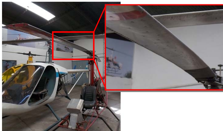
Figura 2: Palas de rotor principal de construcción metálica aplicadas en un Cicaré CH4.
