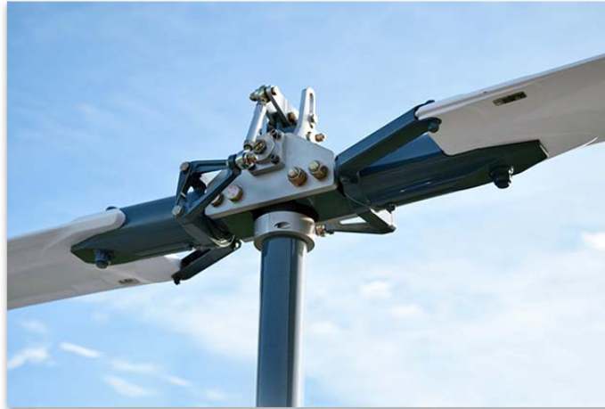
Figura 1: Sistema de rotor principal semirrígido (teetering o seesaw)
