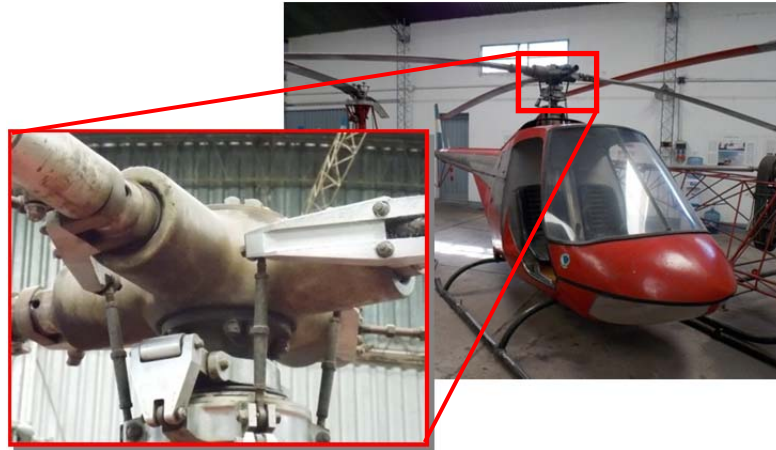
Figura 3: Palas de rotor principal de construcción en materiales compuestos aplicados en un Cicaré CH3 (derecha), cubo de rotor principal de tipo rígido y de materiales compuestos (izquierda).
