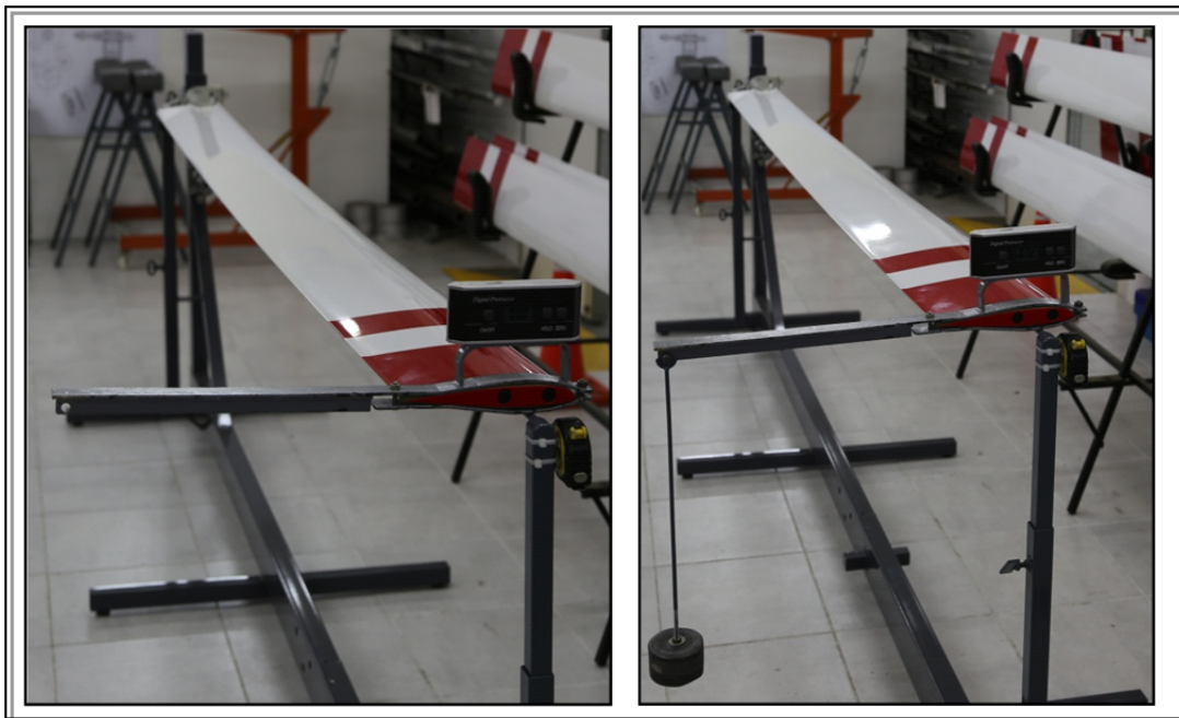
Figura 7: Pala de Cicaré 7 – Cicaré SVH4 montada en el banco para realizarle la medición de rigidez torsional
