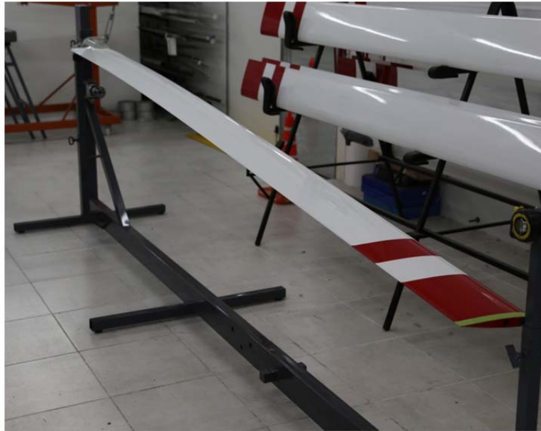
Figura 6: Banco de ensayos con una pala de Cicaré 7 – Cicaré SVH4, montada
