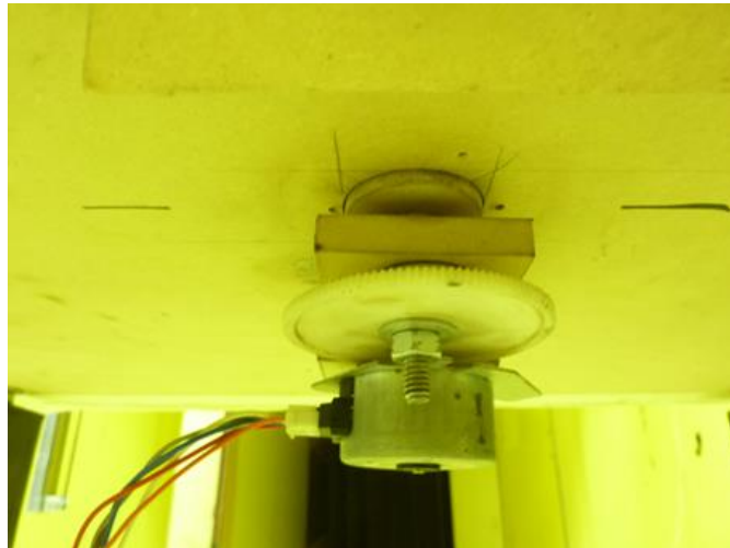
Figura 14: mecanismo de posición del VG
