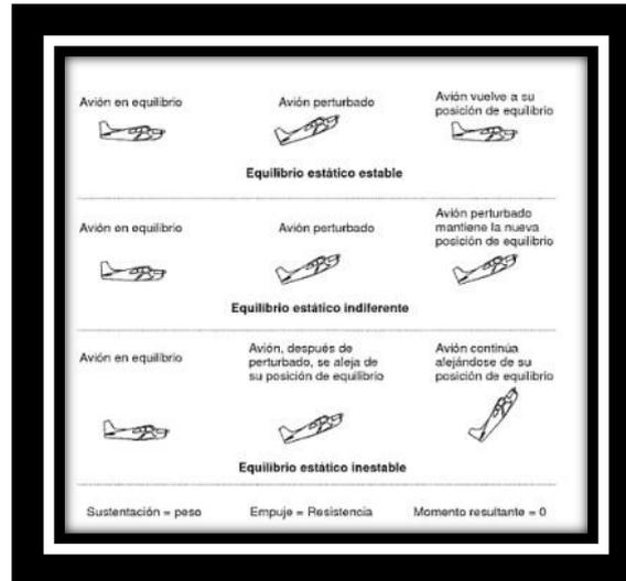
Figura 1. Condiciones de estabilidad estática.
