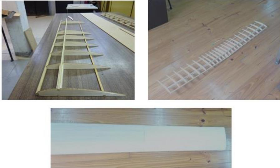
Figura 17. Estructura y enchapado del ala.
