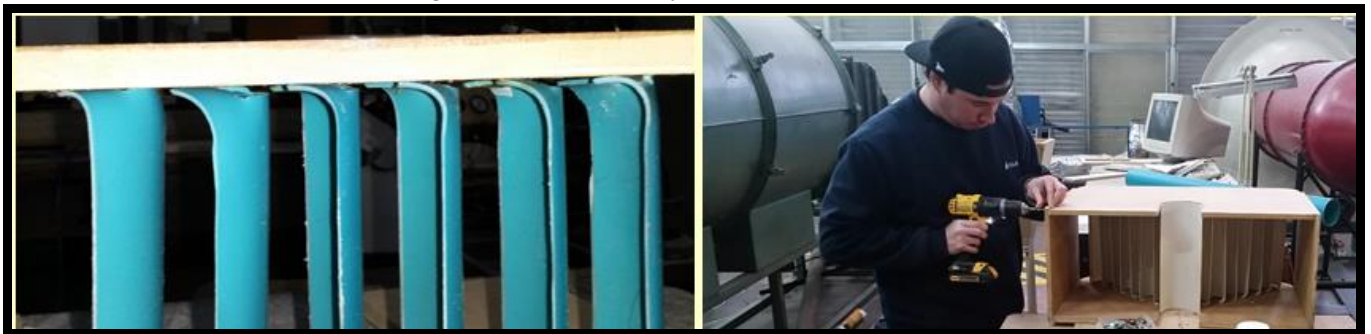
Figura 21. Instalación y alineado de los álabes
