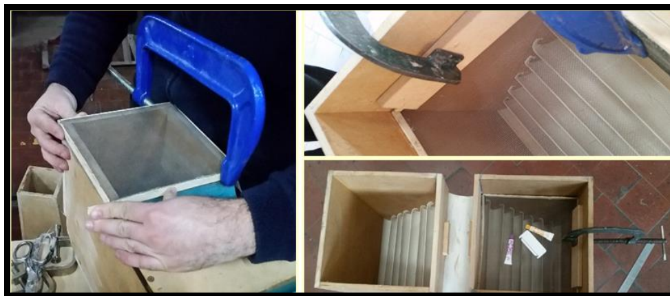
Figura 25. Fijación de las mallas mediante marcos encolados a las paredes del túnel
