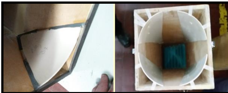
Figura 30. Proceso de carenado de las esquinas de los divergentes 2 y 3
