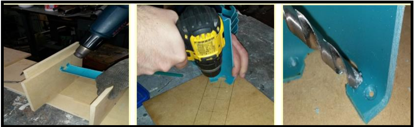
Figura 20. Conformado térmico de las pestañas, perforado y avellanado
