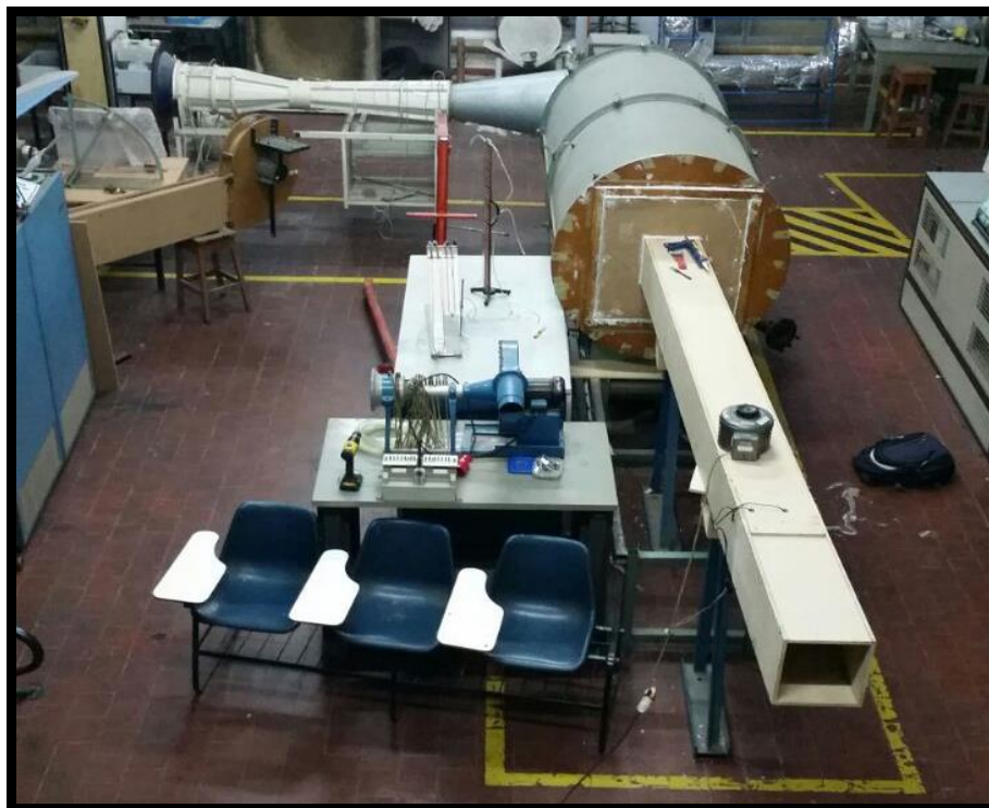
Figura 4. Instalación disponible en el laboratorio, incluye ducto del ventilador
