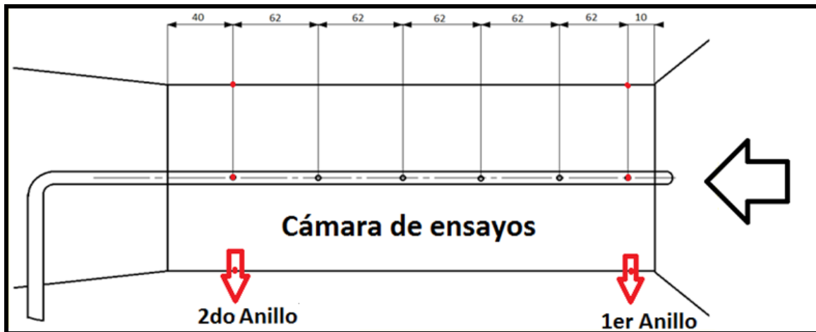
Figura 35. Ubicación de la sonda de presión estática
