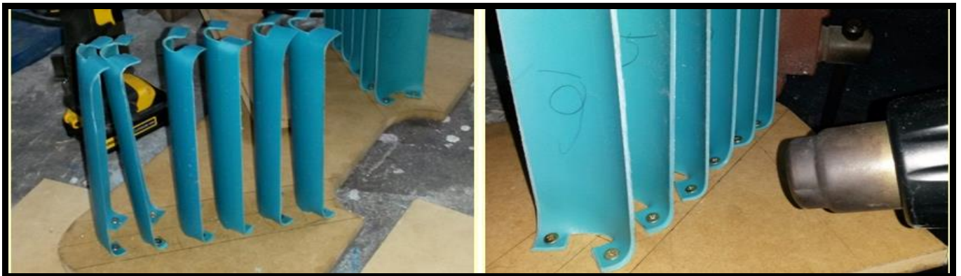
Figura 21. Instalación y alineado de los álabes
