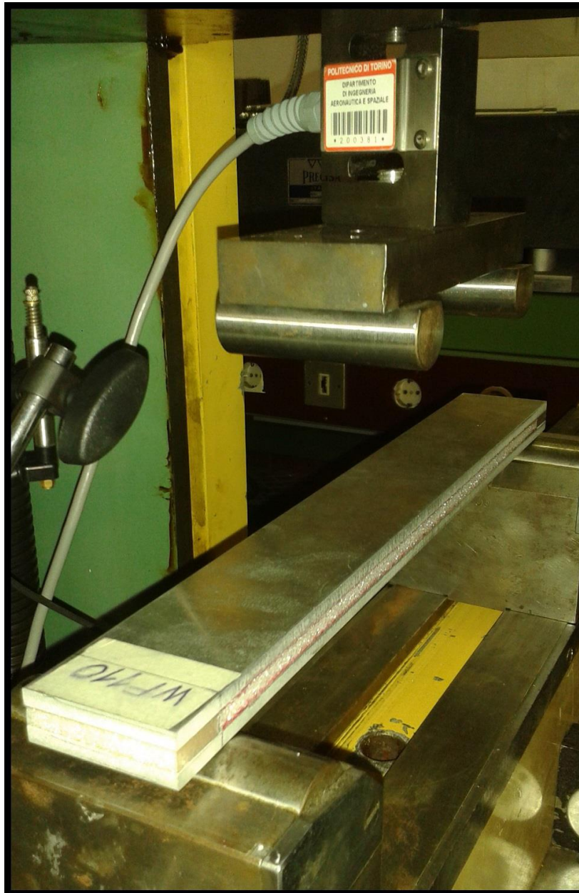
Figura 4.5: Fotografía viga sándwich en posición de ensayo.
