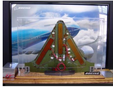
Figura 4 y 5: SMA geometría variable en estructuras (chevron)
