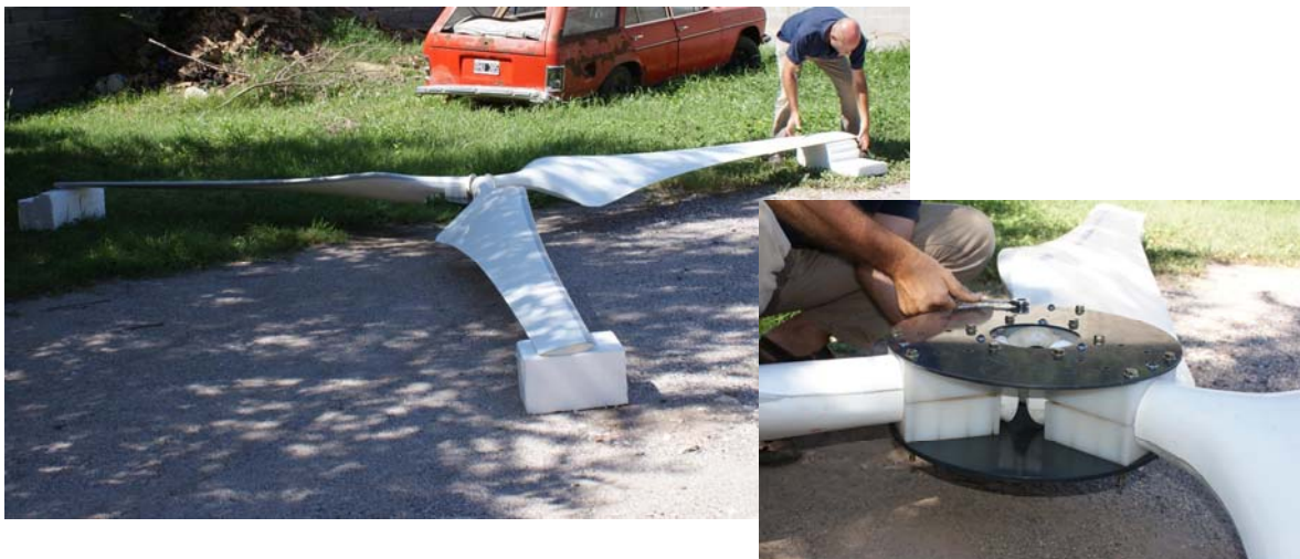
Figura 9: Armado del Rotor, integración de palas al cubo.
