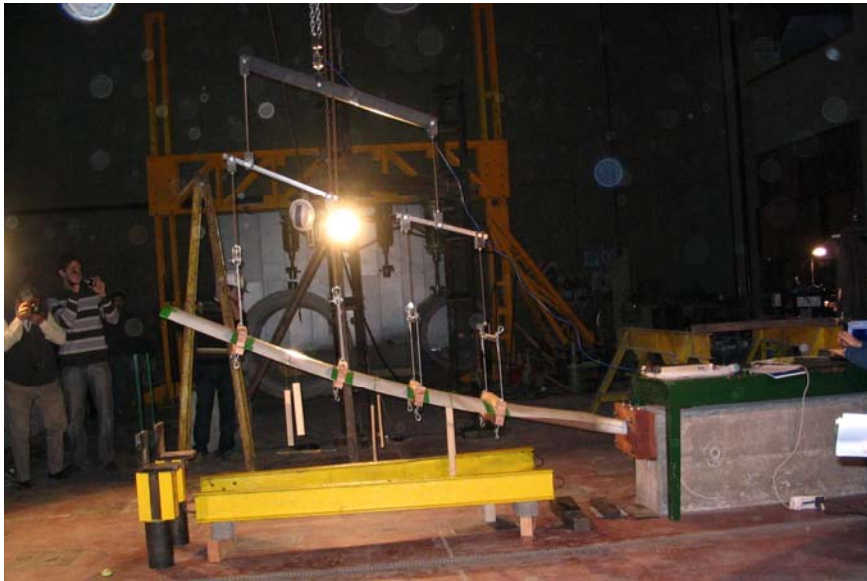
Figura 13: Deflexión de la pala en las distintas etapas del Ensayo Estático de Flexión.
