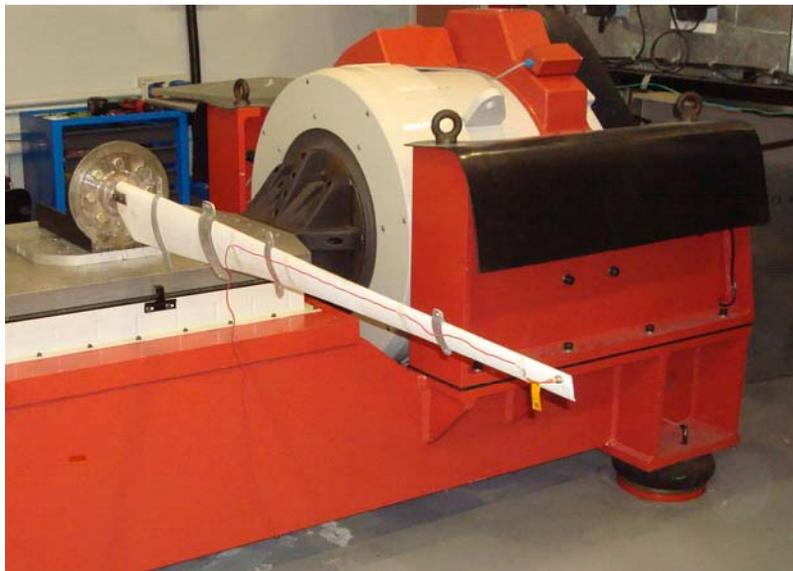
Figura 2: Pala en vibrador, con acelerómetro.
