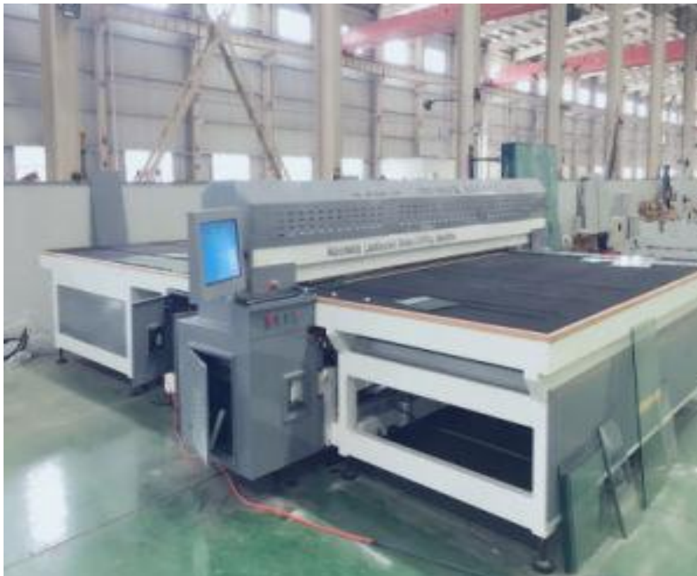
Figura 8: Máquina para proceso de laminado Fuente: Maxor
