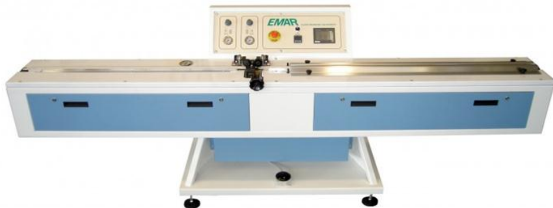
Figura 6: Butiladora de sellado primario ( Fuente: www.tecnicglass.com )
