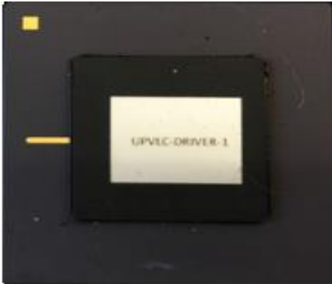
Figura. 3: Envase del chip controlador LiFi (tamaño: 3.3 x 3.3 cm 2 )
