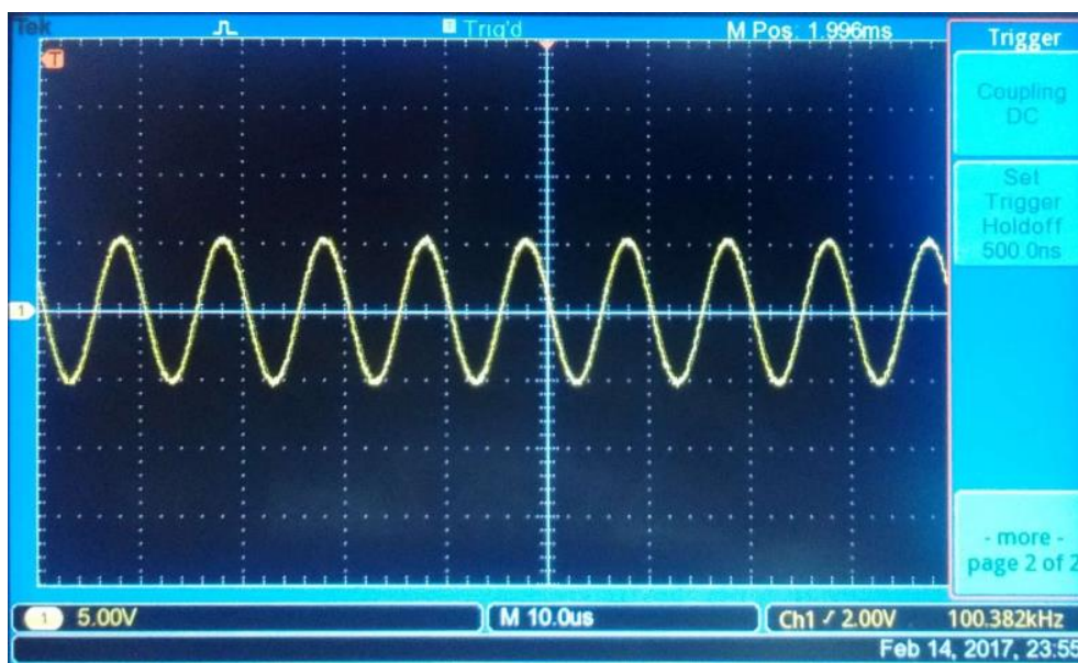
Figura 47: Señal portadora de 100 KHz
