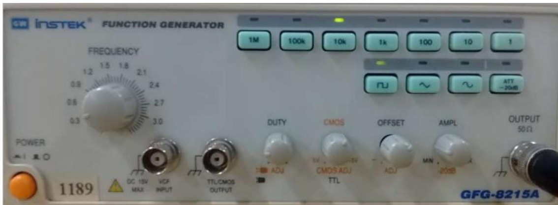
Figura 44: Generador de funciones configurado para entregar una señal cuadrada de 5 KHz
