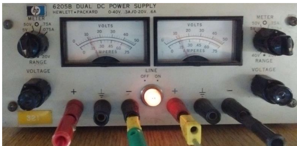
Figura 43: Fuente de alimentación partida configurada para entregar \pm 12 V
