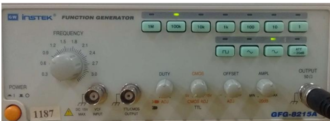
Figura 46: Generador de funciones configurado para entregar la señal portadora de 100 KHz
