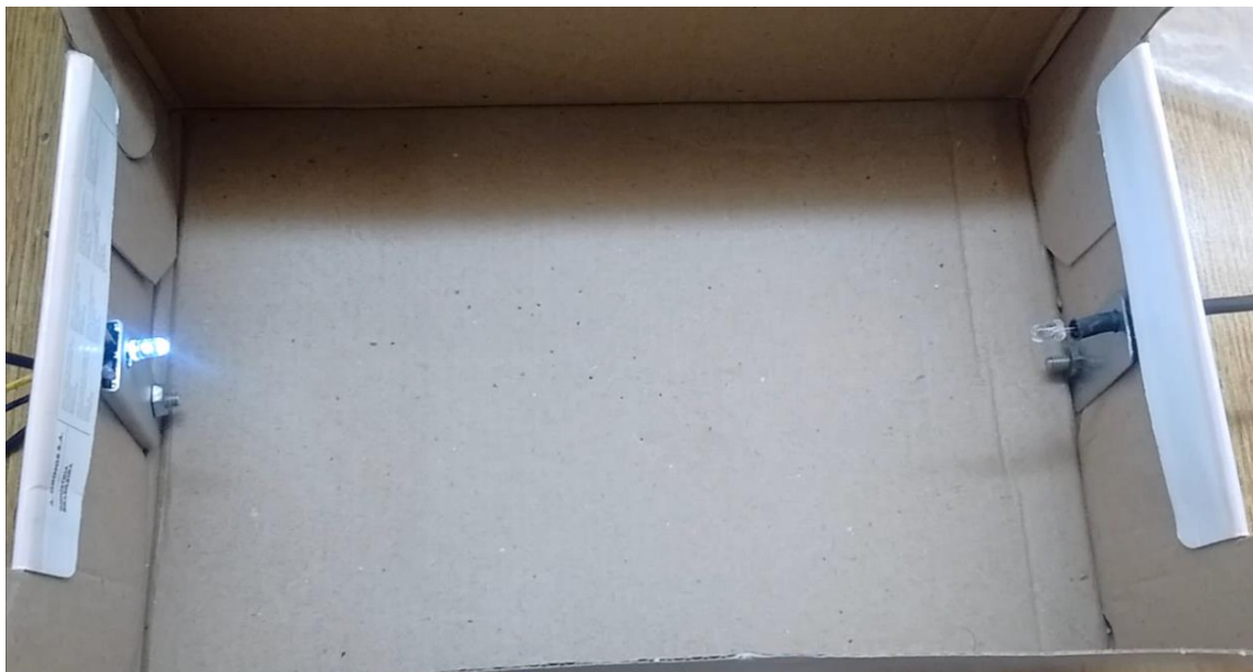
Figura 49: Caja cerrada donde se colocó el LED y el fototransistor
