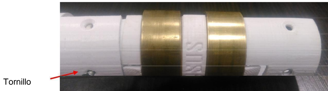
Figura 9. Tuerca (arriba) y tornillo de sujeción (abajo) entre cuerpos plásticos.
