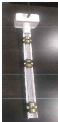
Figura 2. Sonda con sensores a 10, 30 y 60 cm de profundidad.
