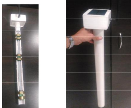
Figura 11. Sonda armada sin el tubo de acceso (izquierda) y dentro del tubo de acceso derecha).
