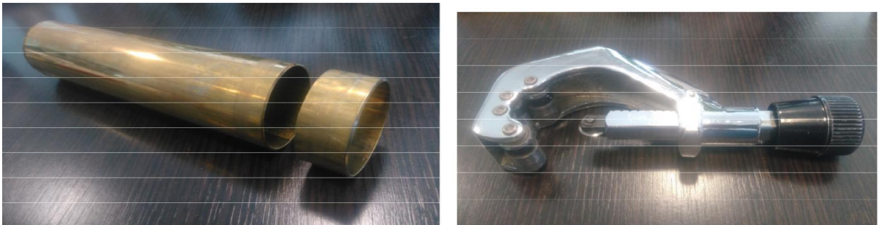
Figura 4. Tubo de latón para obtener los anillos (izquierda), y herramienta de corte de tubo (derecha).
