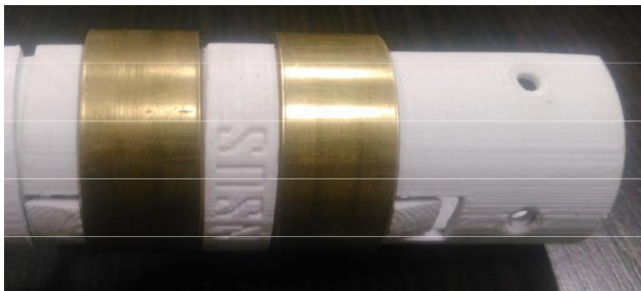
Figura 6. Estructura plástica con anillos de latón sujetos a presión mediante aletas del cuerpo plástico.
