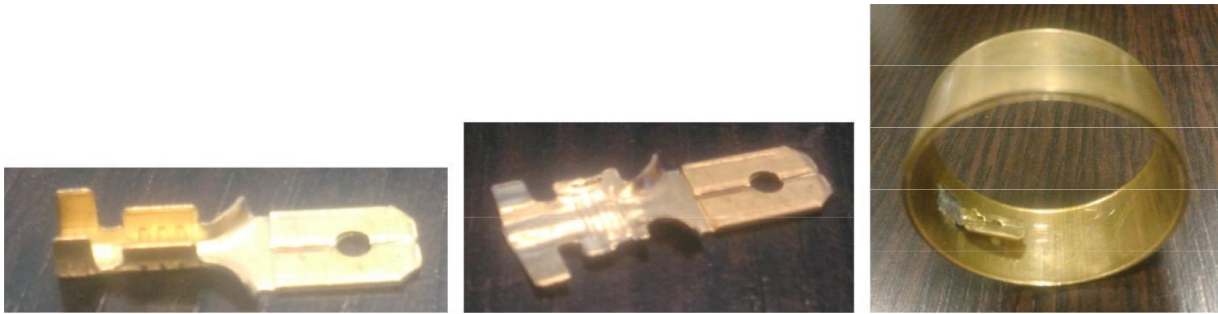
Figura 5. Terminal de conexión eléctrica del anillo (izquierda), terminal aplanado (centro) y anillo de latón con conector soldado con estaño (derecha).
