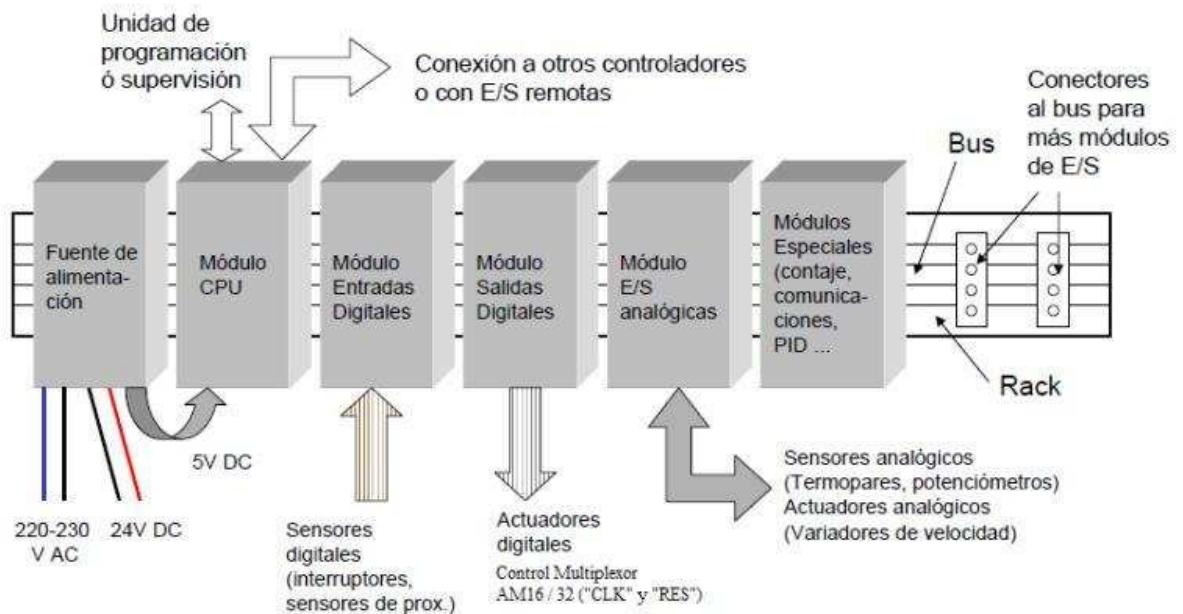
Figura N° 69 Arquitectura Típica de un PLC.
