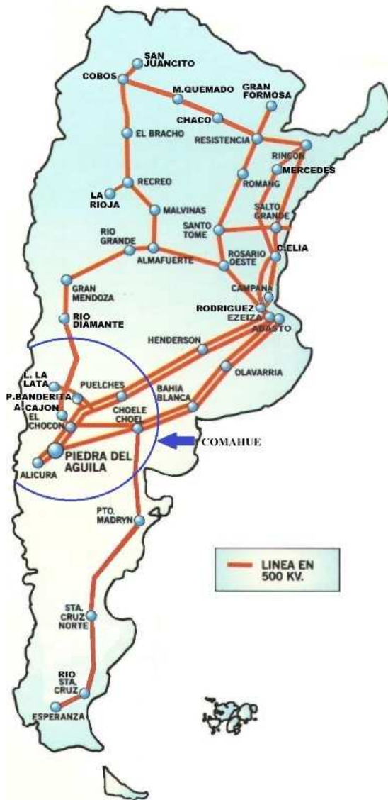
Figura N° 1 Sistema Argentino de Interconexión (SADI)
