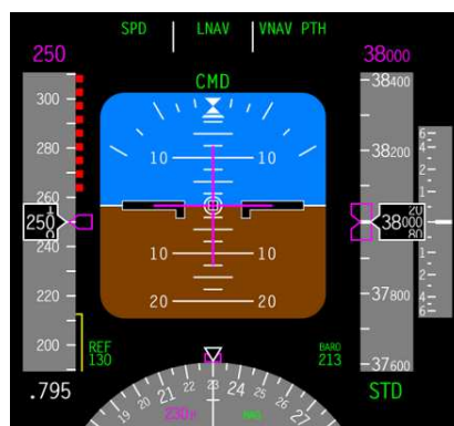
Figura 10: PF D, con Indicador de Situación Horizontal ( H SI), rumbo, velocidad y altitud 95
